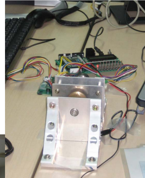
Fig. 実習機材 (モータと制御ボード を机下のHILSと接続)
